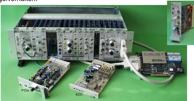
Analog- Regler, Begrenzer u. Interlocks mit PCI-Multifunktionskarte für PC Anschluss
