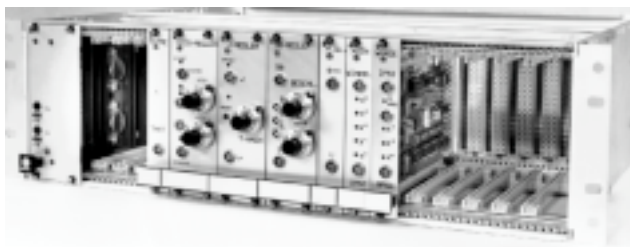
Bild 6: PIDisB-Reglergerät in modularer Bauweise (EuroLab) mit manueller Bedienbarkeit und Rechneranschluß für Fernbedienen und Beobachten
