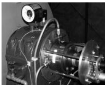
Fig.14a&b Reflex-Lichtschranke an EZ2 zur Synchronisation des Dead-beat-Reglers mit der Generator-Drehzahl (1200...1600U/Min = 20...26Hz)
